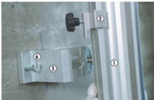
Монтаж рельсовой опоры для стандартной резки
